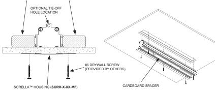
TAPE AND PLASTER AROUND THE HOUSING, ENSURING A SMOOTH SURFACE FINISH. ONCE PLASTERED, 3. REMOVE CARDBOARD SPACER(S) FROM THE HOUSING OPENING.
