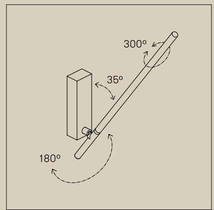
(EN) Wide range of movement: both light source and light axis swivel. (ES) Amplia capacidad de movimientos: rotación tanto de la fuente de luz como de su eje. (FR) Large gamme de mouvements : rotation tant de la source lumineuse que de son axe.
